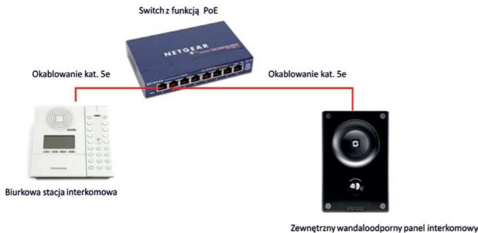
Rys. Przykładowa minimalna konfiguracja systemu Pulse
