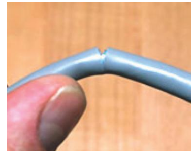
Rysunek 2: Kabel wystawiony na wysokie temperatury z czasem kruszeje i narażony jest na łamanie.
