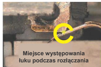
Rysunek 1: Miejsce występowania łuku elektrycznego znajduje się poza końcową pozycją styku.
