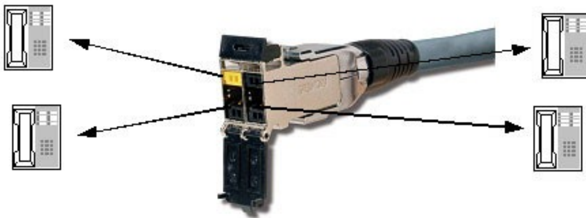
Rysunek 5: Typowe zastosowanie współdzielenia kabla – telefon/faks center
